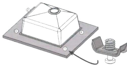
5 Apriete los tornillos de las abrazaderas con un destornillador.
