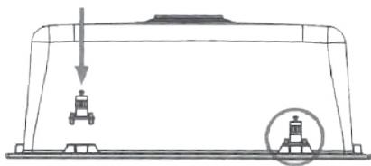
**4** Baje los pivotes completamente hasta su posición.
