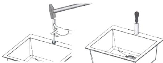
**2** Inserte el clip de fijación en la ubicación preexistente.
